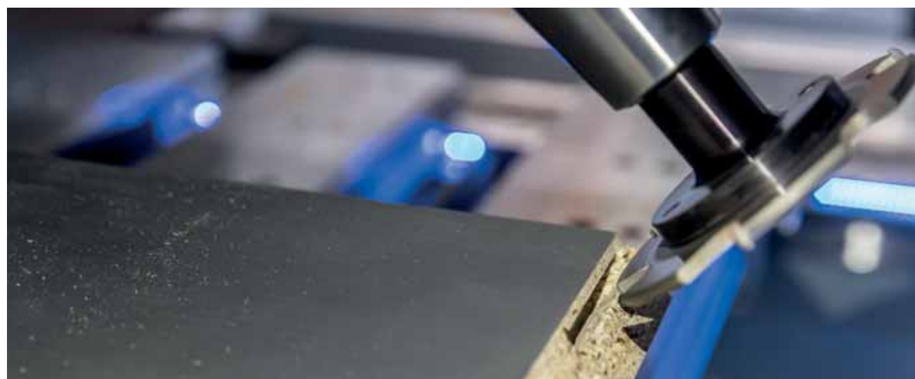
Fresatura della scanalatura P-System con la Homag Venture 316 L CNC 5-assi
