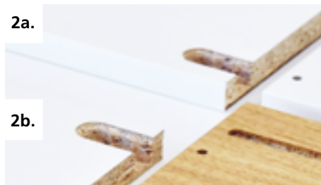
Lavorazione sul pezzo, inclusa la fresatura del profilo del copriforo
