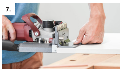
7. Praticare le fresature delle scanalature longitudinale e P-System nel ripiano
