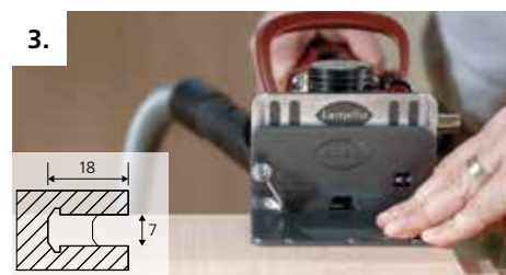
3. Fresare la scanalatura P-System
