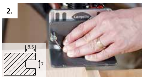
2. Fresare una scanalatura longitudinale
